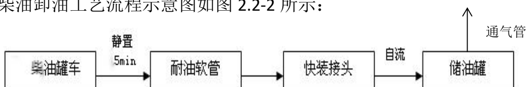
图 2.2-2 柴油卸油工艺流程示意简图
