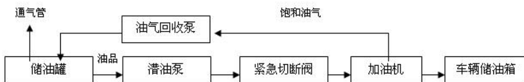
图 2.2-3 汽油加油工艺流程示意简图
