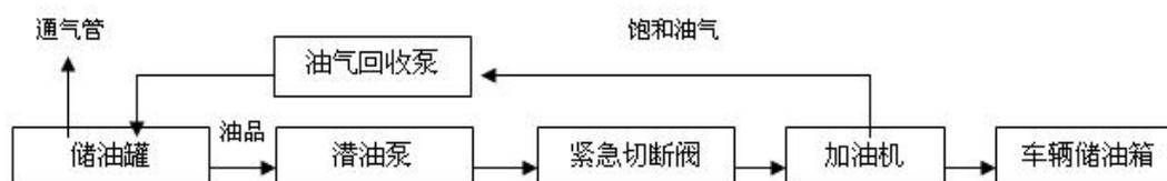
图 2.2-3 汽油加油工艺流程示意简图
