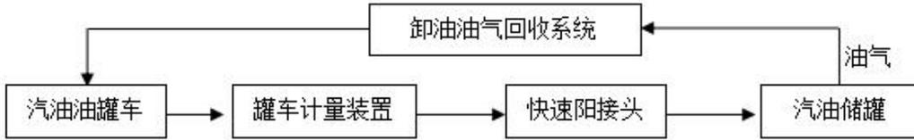
图 2.2-1 汽油卸油工艺流程示意简图
