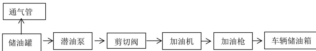
图 2.2-4 柴油加油工艺流程示意简图
