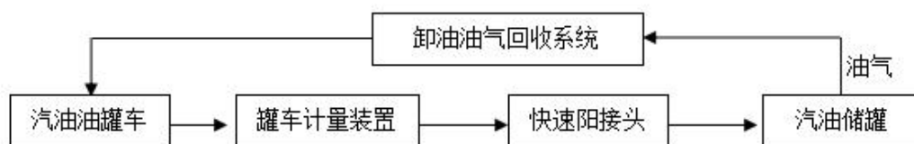
图 2.2-1 汽油卸油工艺流程示意简图
