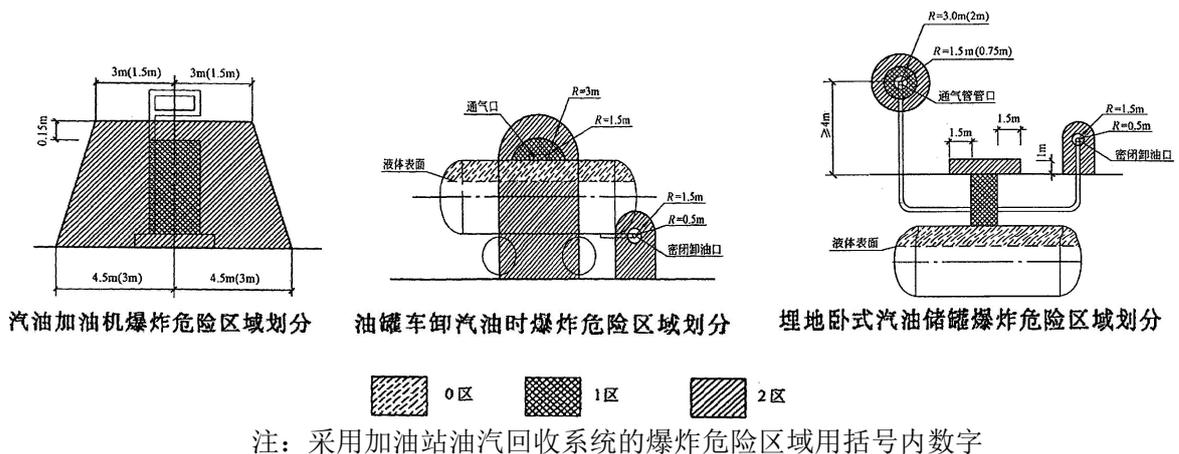
图 3.5.11-1 加油机、埋地汽油罐、卸油口爆炸危险区域划分图
