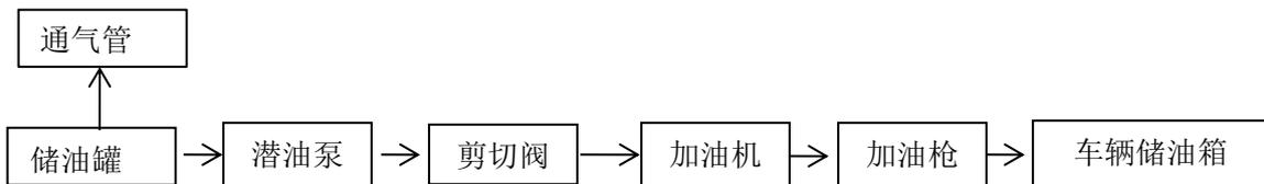
图 2.2.2-4 柴油加油工艺流程示意简图
