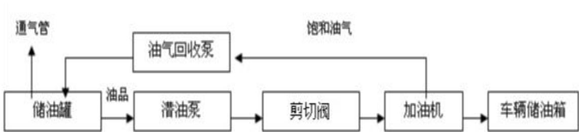
图 2.2.2-3 汽油加油工艺流程示意简图
