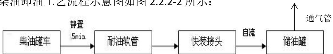
图 2.2.2-2 柴油卸油工艺流程示意简图
