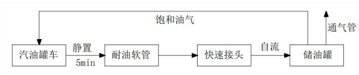
图 2.2.2-1 汽油卸油工艺流程示意简图
